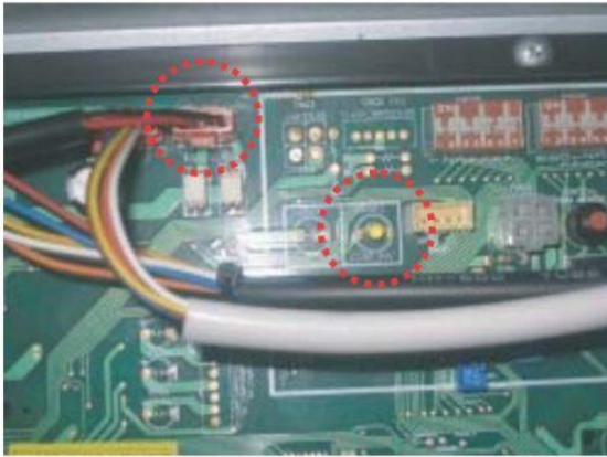
ANA PCB'deki iletim konnektörü ve LED'i
